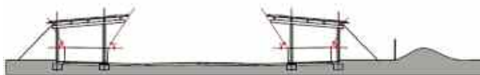
Erste Variante: Rahmentragwerk © AJG Ingenieure GmbH
