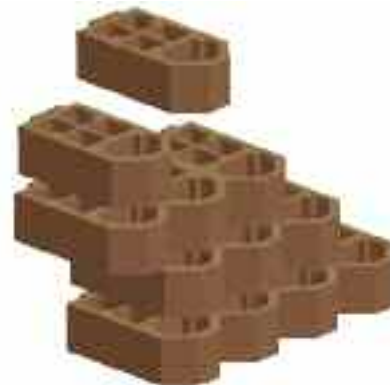
Fertigteile mit Hohlkammern © Betoconcept-Unternehmensgruppe
